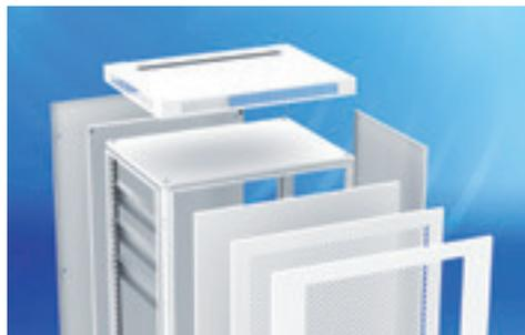
1. Рама выполнена полностью из стали толщиной 2 мм. Углы рамы усилены стальными закладными элементами и сварены двумя роботами непрерывным циклом для придания жесткости и плотности. Профили рам перфорированы с шагом 25 мм для установки оборудования.
