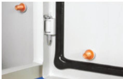
5. Надежное уплотнение достигается благодаря литой прокладке, наносимой роботом методом непрерывной отливки. Литая уплотнительная прокладка может быть перекрашена, устойчива к температурам от -40 до +70 °С (полиуретан), от -60 до +135 °С (силикон).
