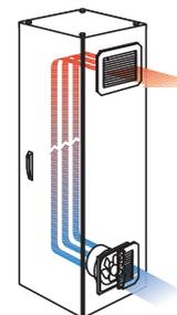
**Применение устройств охлаждения.** Устройства охлаждения используются для понижения температуры внутри шкафа. Применение таких устройств не влияет на степень защиты распределительного щита. Встроенный фильтр обеспечивает их использование в неблагоприятных условиях загрязненного производства, где воздух насыщен частичками пыли и масла
